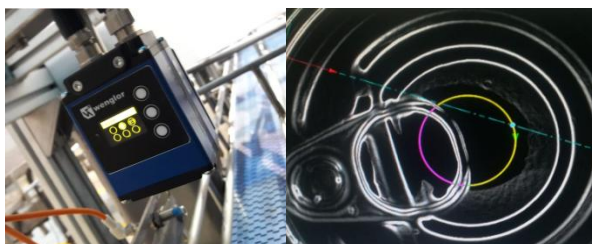
Procesamiento visión artificial y análisis de la tapa de cada lata para realizar el marcado siempre en la zona libre opuesta a la anilla de apertura
