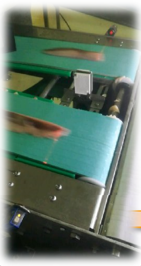
Etapas de alineación, medición laser y entrada a sistemas de visión artificial
