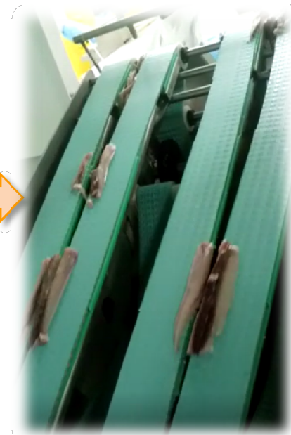
Extracción de recortes y salida de lomos cortados
