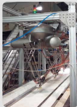
▼ Colaboración de robots Delta para aplicaciones de posicionado a muy alta velocidad, guiados mediante visión artificial.
