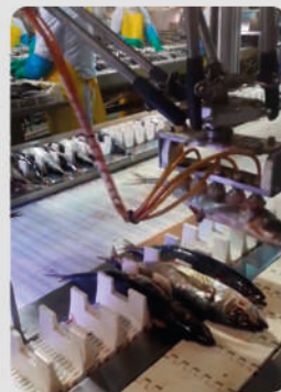
▼ Colaboración de robots Delta para aplicaciones de posicionado a muy alta velocidad, guiados mediante visión artificial.
